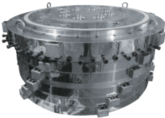
三層模頭1500mm 3 Layer Die Head 1500mm
